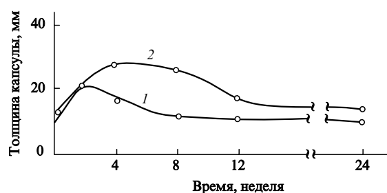
Рис. 1. Зависимость толщины капсулы от времени имплантации. 14 1 — полидиметилсилоксан; 2 — полистирол, покрытый полидиметилсилоксаном
